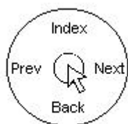
Figura 2. Un esempio di Pie Menu a quattro settori al momento del suo richiamo
